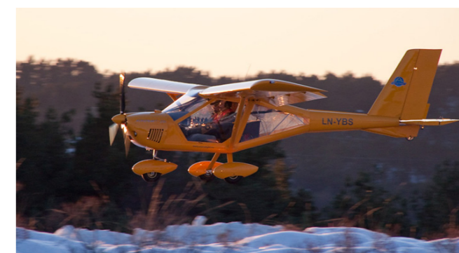
Aeroprakt A-22 produseres i Ukraina og har et hastighetsområde fra 55 til 200 km/t. Foto: via Olav Laurhammer
